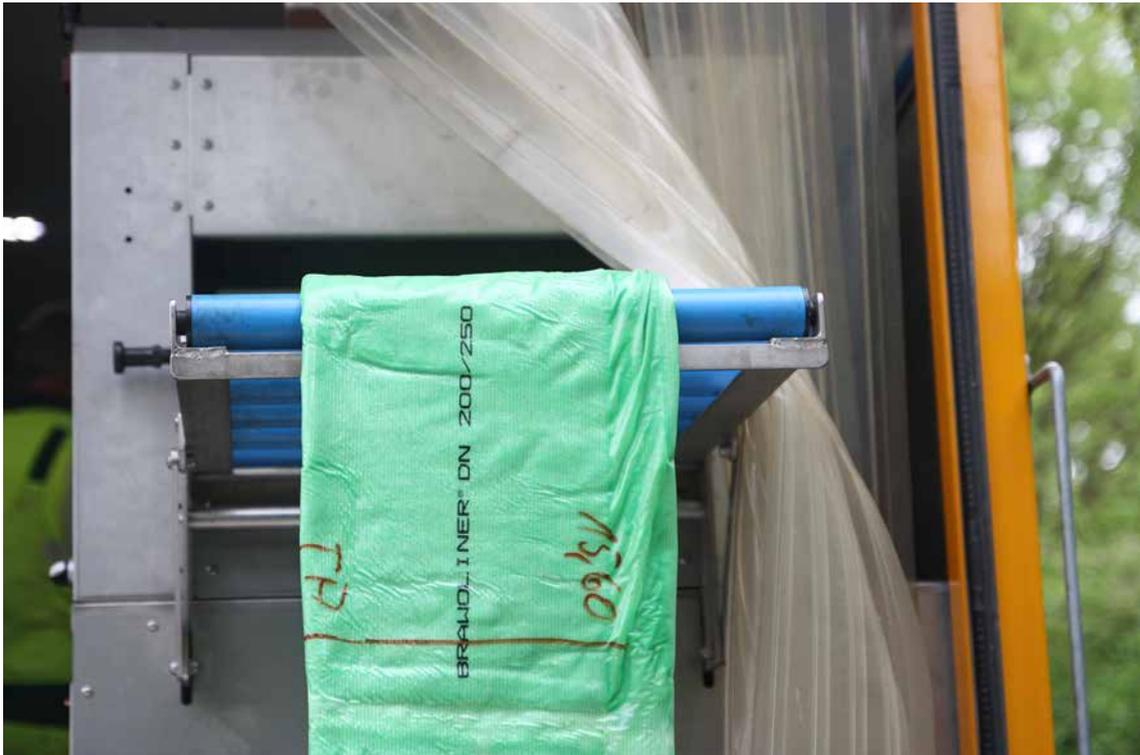
Nach Passieren der Kalibrierwalzen ist der Schlauchliner fertig getränkt.
